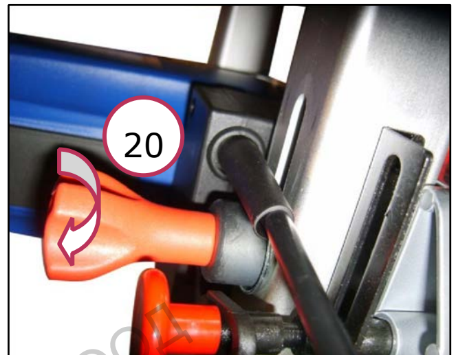
Фигура 11 – Настройка на височината на масата.
